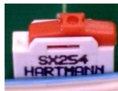
Schakelstand rechts (afleveringstoestand)
