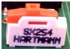
Posición del interruptor a la izquierda (estado de entrega)
