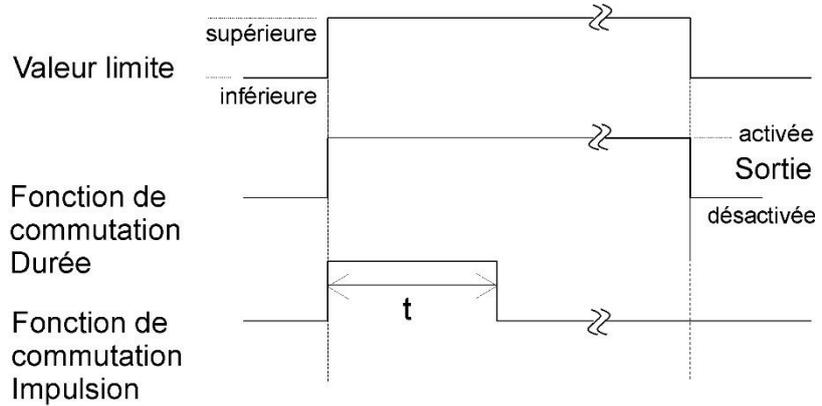
mode de fonctionnement double point (uniquement pour valeur limite supérieure)    valeur supérieure dépassée -> sortie VL2 établit une connexion
