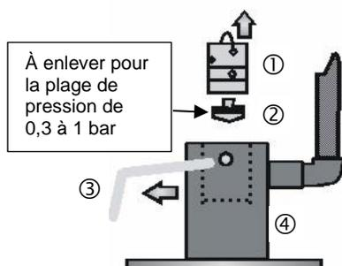
Lors d'une pression inférieure à 0,3 bar, ou lors d'une aspiration dans une cuve, il est possible d'utiliser notre [pompe de charge MepuClip](#).
