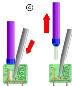
1. Introduire le tournevis dans l'ouverture carrée sans exercer de pression sur le côté afin d'ouvrir les logements de borne. Lorsque le logement de borne est ouvert retirer le conducteur.
