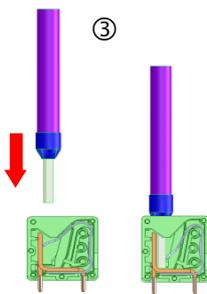
Ligue os condutores com isolador de terminal ou o condutor rígido ao orifício para a entrada de cabos.
