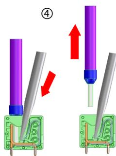
1. Insira a chave de fendas sem exercer força lateral, na abertura para abrir o ponto de fixação do terminal.
