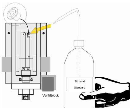
Le niveau de remplissage baisse jusqu'à atteindre le volume d'échantillon prévu. La valeur de mesure est déterminée et la valeur de correction est calculée. Le facteur est affiché sur l'écran.
