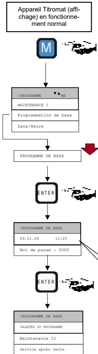
La saisie des données et des paramètres dans le programme de base nécessite un mot de passe à quatre chiffres. Le mot de passe est la suite de chiffres inversée correspondant à l'heure actuelle de l'appareil Titromat® TH - .
