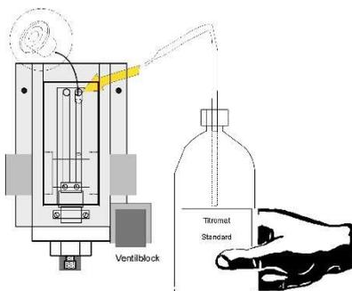
Der Füllstand sinkt bis auf das vorgesehene Probevolumen ab. Der Messwert wird ermittelt und der Korrekturfaktor berechnet. Der Faktor wird im Display angezeigt.
