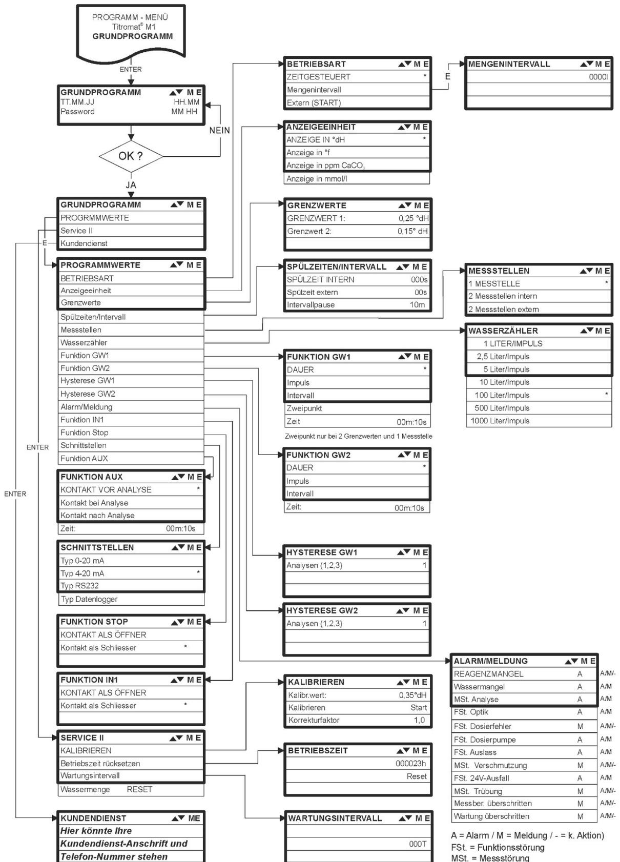
**Zum Aufruf der werkseitigen Grundprogrammierung ist das Gerät bei gleichzeitigem Gedrückt halten der beiden Tasten "M" und "I" einzuschalten. ACHTUNG, die letzte Programmierung geht verloren!**
