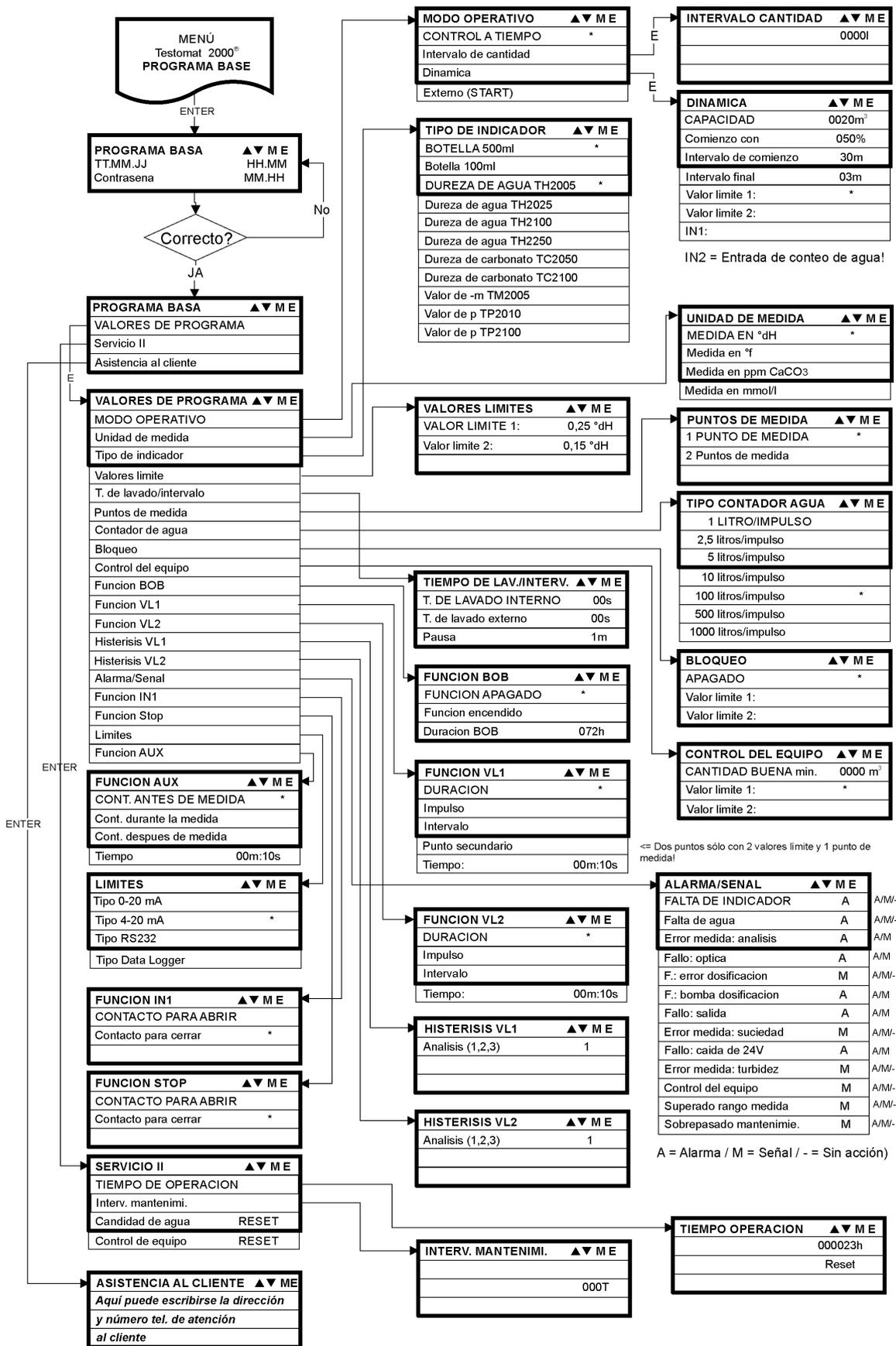
Para acceder a la programación básica de fábrica debe encenderse el equipo manteniendo presionadas las teclas "M" e "i" simultáneamente. ¡ATENCIÓN: la última programación se pierde!
