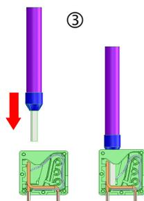
Insérer le conducteur pourvu d'un embout ou le conducteur rigide dans les cônes d'entrée ronds.
