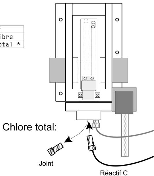
2.) Pour passer du Chlore libre au Chlore total, vous devez sélectionner le paramètre A Chlore total A dans le menu A M A et brancher le tube d'aspiration du réactif C sur le bloc support de la chambre de mesure.
