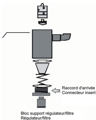
Fixer les raccords des flexibles sur le boîtier du filtre.
