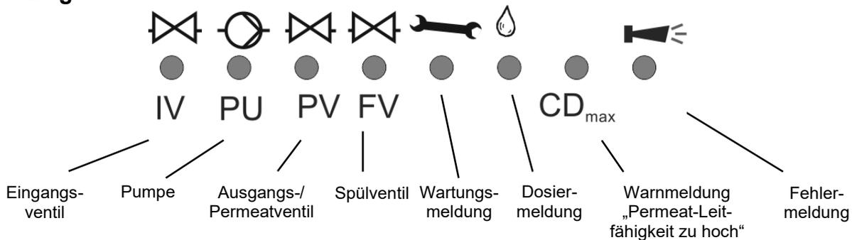
Die Anzeigen signalisieren aktive Anlagenkomponenten und anstehende Fehlermeldungen.
