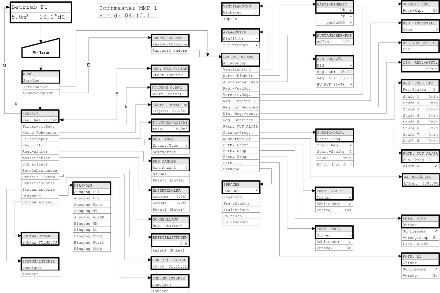
Zum Aufruf der werkseitigen Grundprogrammierung ist das Gerät bei gleichzeitigem Gedrückthalten der Taste "Pfeil nach unten" einzuschalten. Die letzte Programmierung geht verloren.
