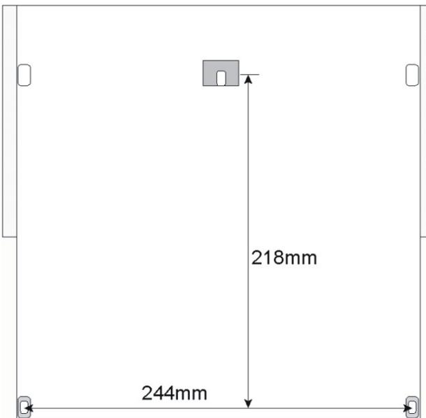
Schalttafel Ausschnitt bei Einbau
