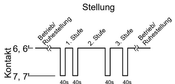
Für Ausführungen mit Impulsschalter schaltet der Ausgang zu Beginn jeder Stufe für 40 Sekunden (Klemme 7 bzw. 7').
