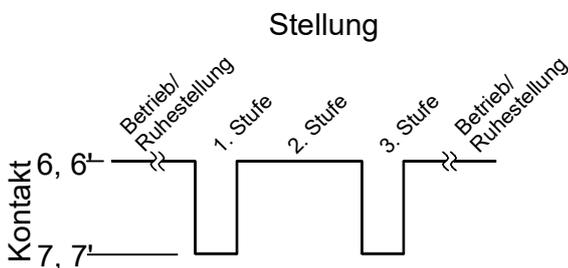
Für Ausführungen mit Wechsler schaltet der Ausgang nach jeder Regenerationsstufe. Bei ungerader Zahl mechanischer Stellungen muss die Rückstellung in die Betriebsstellung über den Synchron-Kontakt (Betriebsschalter) erfolgen.
