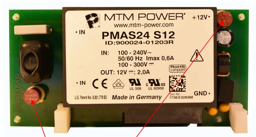
Netzteil F2: Sicherung T0,63A
