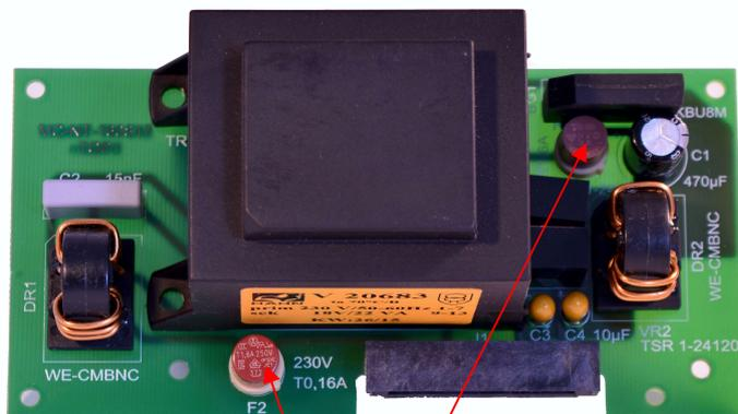
Netzteil F2: Sicherung T0,16A
