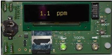
Über das Display kann kein Menü für die Programmierung aufgerufen werden. Es ist nur für die Messwertanzeige geeignet. Zum Programmieren des Gerätes verwenden Sie den Service Monitor (siehe [Das Programm Service Monitor](#) auf Seite 27).
