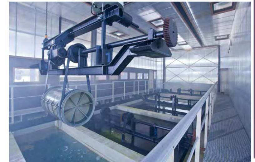
Bei galvanischen Prozessen wie der Verkupferung, Verchromung oder Vernickelung oder bei der Oberflächenbehandlung vor einer Lackierung (Phosphatieren) werden nach jedem Prozessschritt große Spülwassermengen benötigt.
