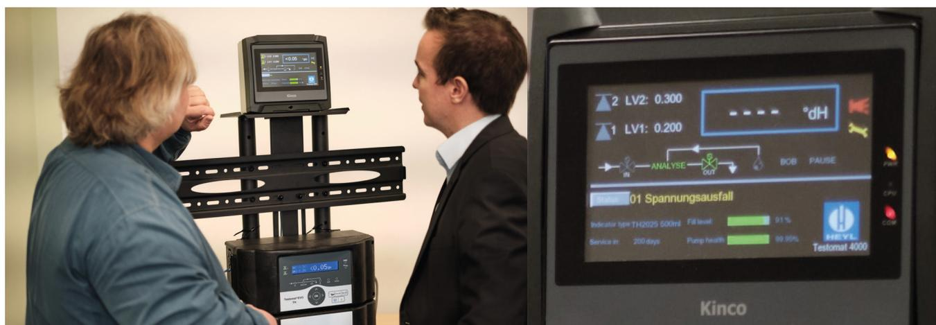
Abbildung 2: Links: Das zur Etablierung digitaler Geschäftsmodelle mit Unterstützung des Kompetenzzentrums weiterentwickelte Wasseranalysegeräte. Rechts: Detailansicht der Leitwartenvisualisierung mit u.a. Anzeige des Gesundheitszustandes der Pumpe und der Dauer bis zum nächsten Service.
