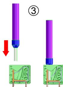
Leiter mit Aderendhülse oder den starren Leiter in den runden Kabeleinführungstrichter stecken.
