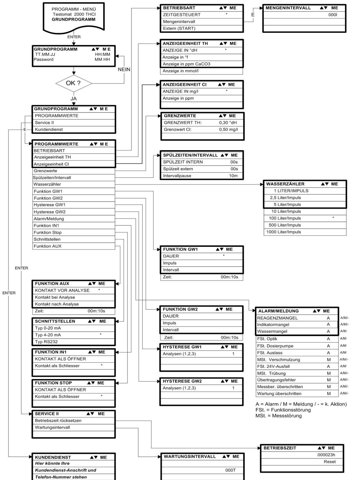
Zum Aufruf der werkseitigen Grundprogrammierung ist das Gerät bei gleichzeitigem Gedrückthalten der beiden Tasten "M" und "I" einzuschalten. **ACHTUNG**, die letzte Programmierung geht verloren!
