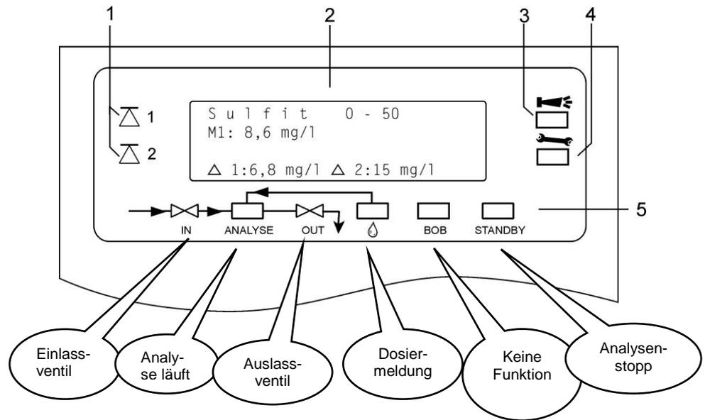
Alle Fehler- und Warnmeldungen werden im Wechsel mit der Standardanzeige im Display in Zeile 1 angezeigt!
