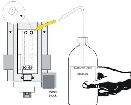
Der Füllstand sinkt bis auf das vorgesehene Probenvolumen ab. Der Messwert wird ermittelt und der Korrekturfaktor berechnet. Der Faktor wird im Display angezeigt.
