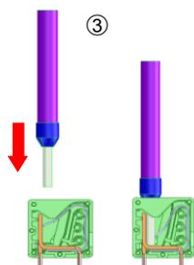
Insérer le conducteur pourvu d'un embout ou le conducteur rigide dans les cônes d'entrée ronds.
