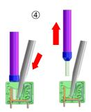
Introduire le tournevis dans l'ouverture carrée sans exercer de pression sur le côté afin d'ouvrir les logements de borne.
