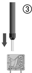
将套管电缆或电缆芯插入圆形电缆端口.
