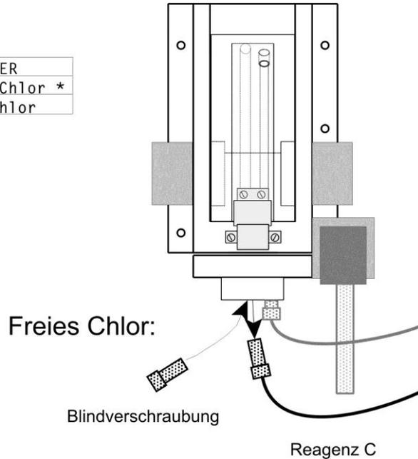
2.) Wenn Sie mit dem Gerät freies Chlor gemessen haben und ändern den Parameter auf **Gesamtchlor**, müssen Sie den Druckschlauch des Reagenz C an der Messkammeraufnahme anschließen!
