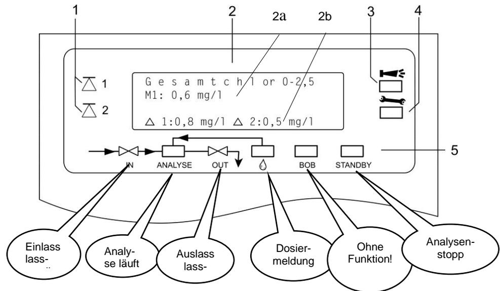
Alle Fehler- und Warnmeldungen werden im Wechsel mit der Standardanzeige im Display in Zeile 1 angezeigt!
