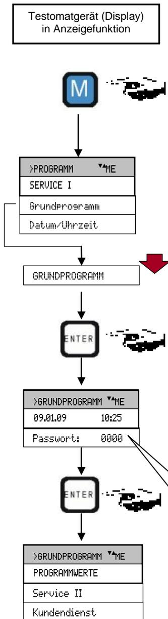
Für Dateneingabe und Einstellungen im Grundprogramm ist ein vierstelliges Passwort nötig. Das Passwort besteht aus der umgekehrten Ziffernfolge der aktuellen Uhrzeit des Testomat 2000® CLO2 - Gerätes.
