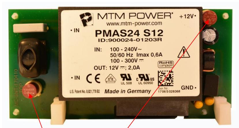
Netzteil F2: Sicherung T0,63A
